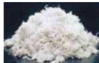
アスベスト (化学式 3MgO \cdot 2SiO_2 \cdot 2H_2O ) 住宅建材として広く使われてきた天然鉱石。中皮腫や肺ガンなど、人体への健康被害が大きな社会問題になり使用禁止になった。
